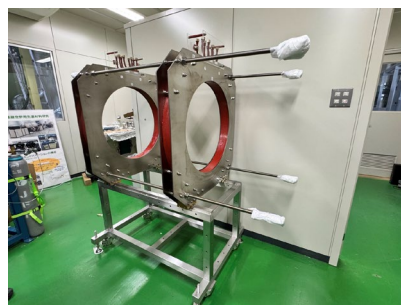
図 1 本支援により導入したプラズマ照射装置用コイル（2 台）および基盤研究（B）〔成果 7〕により整備した架台。
